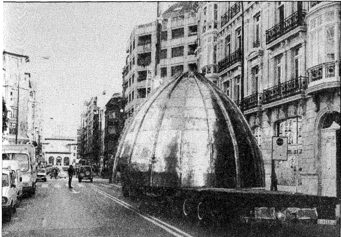
Un transporte especial fue utilizado para trasladar la cúpula, que pesa seis toneladas
