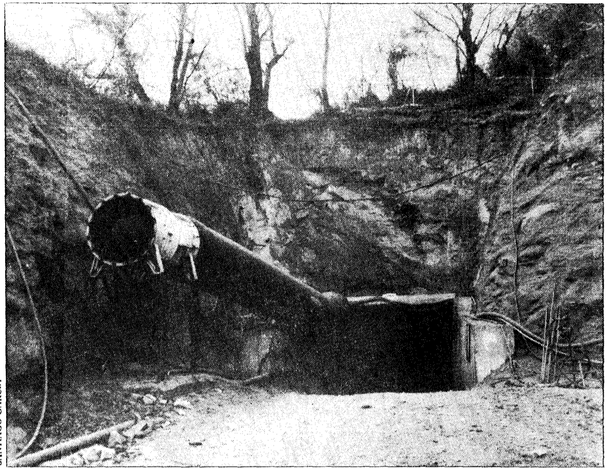
A la izquierda, dos mineros extraen mineral por algunos puntos seleccionados en la segunda fase de exploración de la mina de la La Vega (Salas). Sobre estas líneas, la entrada a la mina, con el tubo de ventilación en primer plano. La entrada a la rampa de acceso tiene una anchura de cuatro metros por tres y medio para que puedan acceder los vehículos y sacar con ellos el mineral al exterior.
